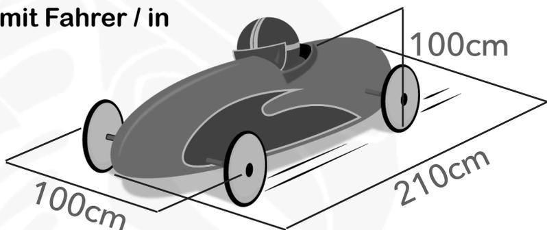
**Das Fahrzeug muss mit der Bremsvorrichtung zu jeder Zeit zum Stehen gebracht werden können!**
